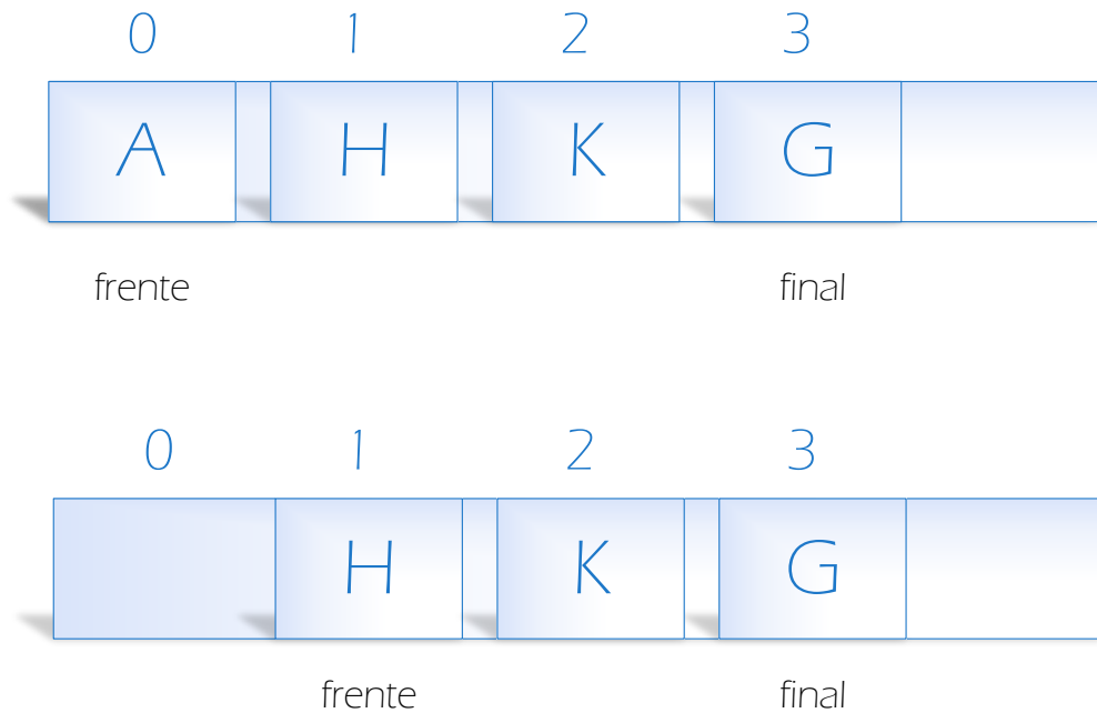
Figure 4: Cola lineal basada en arreglos.
