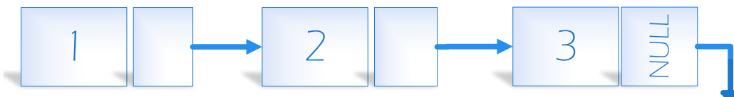
Figure 3: Implementación de una pila basada en lista ligada.
