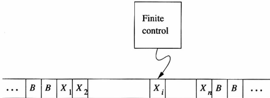
Formalmente, una máquina de Turing es una séptupla:  $M = (Q, \Sigma, \Gamma, \delta, q_0, B, F)$ , donde:
