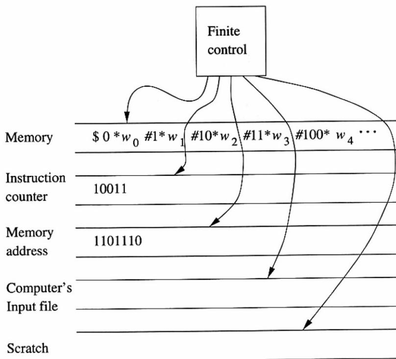
Se puede demostrar que si una computadora tiene sólo instrucciones que incrementan la longitud del tamaño de las palabras en 1 y las instrucciones de tamaño  $w$  se pueden realizar en una TM con cintas múltiples en  $O(k^2)$  pasos, entonces una TM parecida a la mostrada arriba pueden simular  $n$  pasos de la computadora en  $O(n^3)$  pasos.
