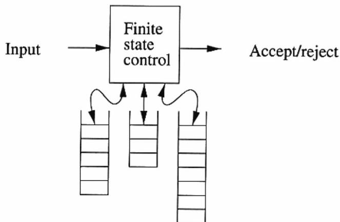
Una máquina de  $k$ -stacks es un PDA determinista con  $k$  stacks. Un movimiento en esta máquina, cambia el estado y reemplaza el símbolo de arriba de cada *stack* con una cadena normalmente diferente para cada *stack*.
